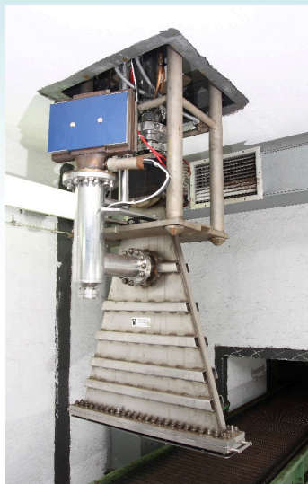
Akcelerator elektronów Elektronika 10-10 znajdujący się w Instytucie Chemii i Techniki Jądrowej
